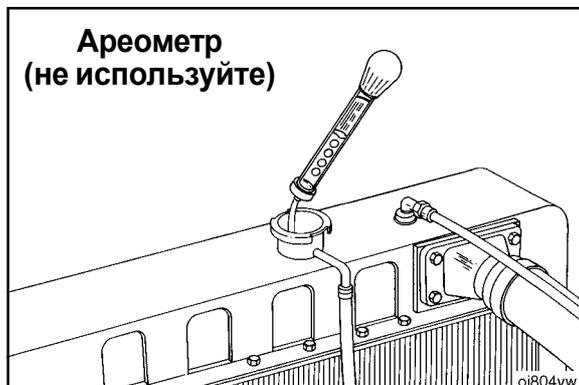
Применение ареометров поплавкового типа может дать не-правильные показания.
