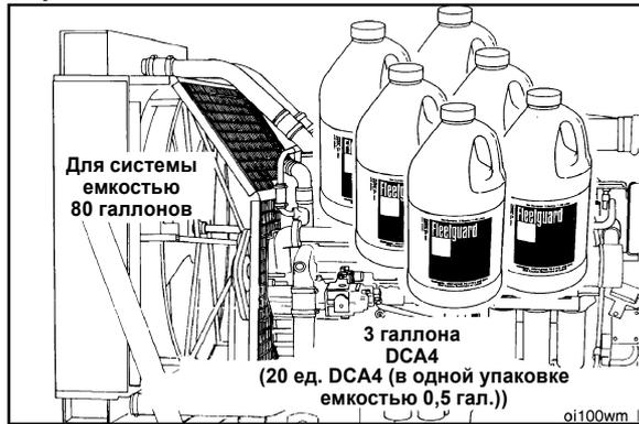
При приговлении охлаждающей жидкости с надлежащей концентрацией присадки SCA для системы охлаждения емкостью, скажем, 80 галлонов (или 300 литров), в охлаждающую жидкость **следует** добавить три (3) галлона жидкой присадки DCA4 при норме 1,5 ед. DCA4 на 1 галлон емкости системы.
