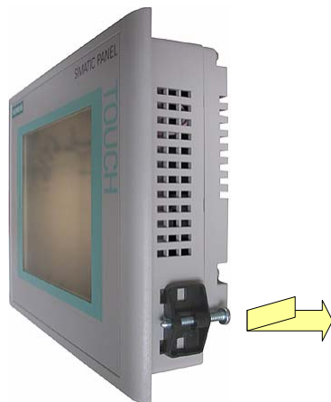
Рисунок 4-11 Установка винтовых зажимов на устройстве НМІ
