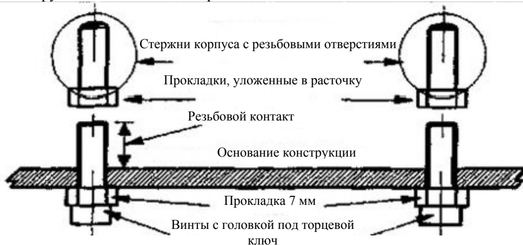
Рис. 8. Монтаж генератора без опоры
